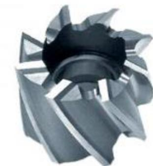
**Cilíndricos frontales sin vástago:** solo hay un tipo de dentado. Poseen dientes tanto en el exterior como en la cara lateral, principalmente son utilizadas para ranurado profundo.
