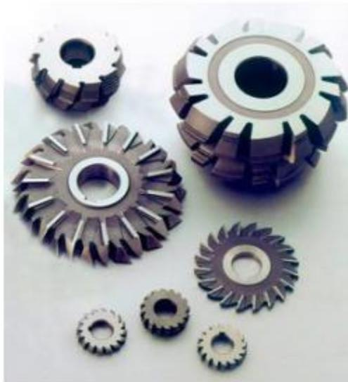
**Compuestas:** Se crean montando distintos tipos de fresas de distinto tipo para crear una que contenga las propiedades de todas las que la conformen. Realiza la función de una fresa de perfil constante además mucho más económica.
