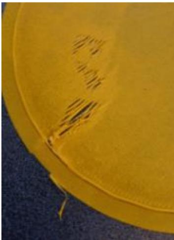
El defecto mostrado en la figura se debe casi con seguridad a que la plataforma de impresión se encuentra demasiado pegada al pico. Esto hace que esa primera capa sea apenas una lámina
