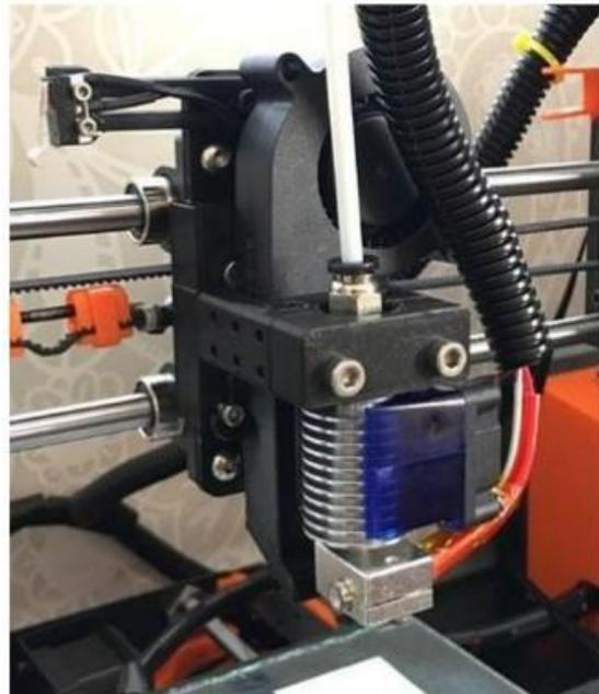
fija) y está conectado al Hotend de la misma a través de un tubo de teflón, por dentro del cual se desplaza el filamento que el extrusor acciona.
