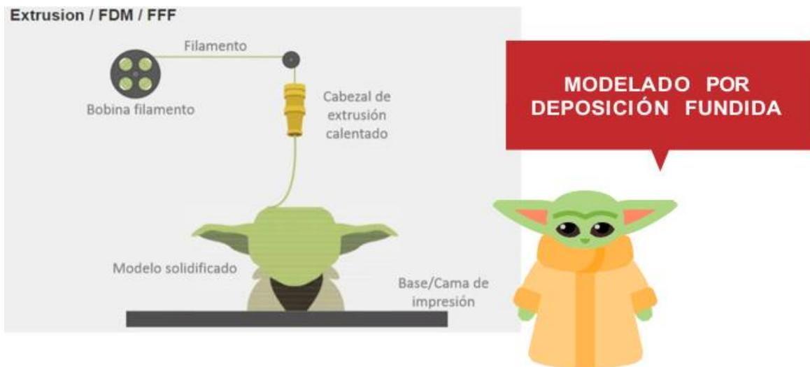
Una vez que la plataforma calefaccionada y el pico del extrusor llegan a las temperaturas configuradas, comienza a extruirse un filamento de material sobre la plataforma a través de una boquilla que se mueve sobre 3 ejes (x, y, z) comandada por un código-G generado previamente en un software de impresión 3D. Al finalizar cada capa, la plataforma se separa del extrusor y comienza la impresión de la siguiente.
