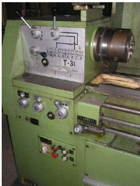
Otra vista con la Caja Norton con sus palancas. ↗
