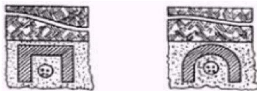
Clase de recubrimiento      Recubrimiento con ladrillos estando el espacio hueco cubierto con arena.
