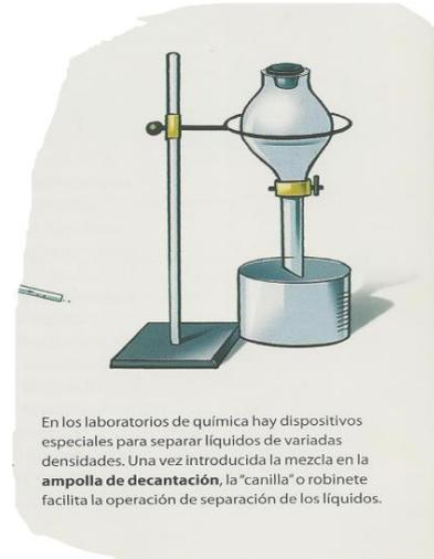
En los laboratorios de química hay dispositivos especiales para separar líquidos de variadas densidades. Una vez introducida la mezcla en la **ampolla de decantación**, la "canilla" o robinete facilita la operación de separación de los líquidos.
