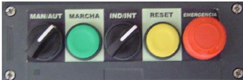
Panel de mando académico únicamente formado por controladores sin la presencia de dispositivos informativos visuales DIV
