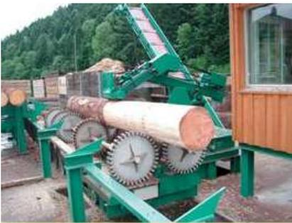
5. **Tronzado.** Los troncos se cortan en trozos, según la longitud deseada, con sierras circulares. Después, los trozos son cortados en tablas o tablones de determinadas medidas, según planos paralelos a su eje.
