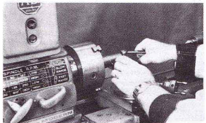
FIGURA 4-2 La ropa suelta puede atorarse fácilmente en piezas móviles de la maquinaria. (Cortesía de Kelmar Associates).
