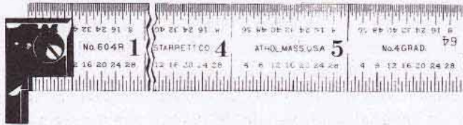
FIGURA 7-5 Se utiliza una regla de gancho para hacer mediciones precisas desde un borde u hombro. (Cortesía The L.S. Starrett Co.)
