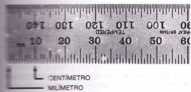
FIGURA 7-2 Las reglas métricas por lo general están graduadas en milímetros y medios milímetros. (Cortesía de Kelmar Associates.)
