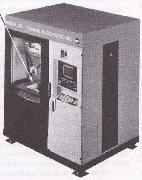
FIGURA 1-12 Las máquinas EDM eliminan porciones de metal mediante un proceso eléctrico de erosión por chispa. (Cortesía de Charmilles Technology Corp.)
