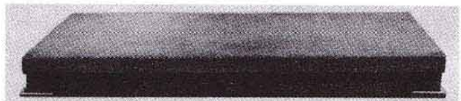
FIGURA 8-10 Los mármoles de granito no son afectados por cambios en humedad y temperatura. (Cortesía de Kelmar Associates.)
