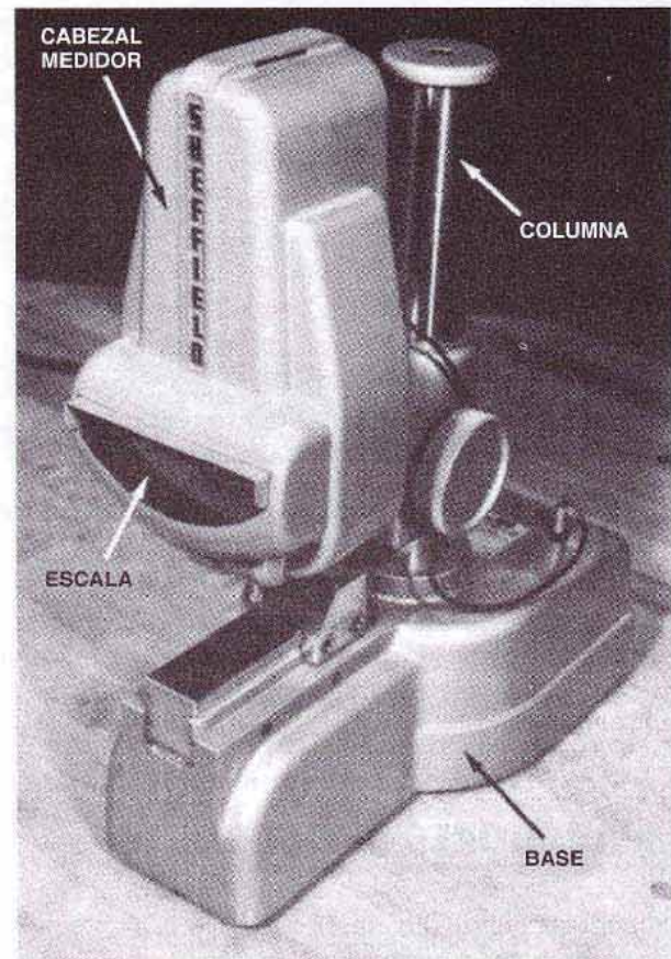
FIGURA 15-12 Un comparador de tipo de lengüeta utiliza principios tanto mecánicos como ópticos para la medición. (Cortesía de Sheffield Measurement Div.)
