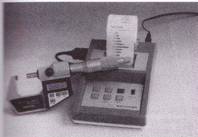
FIGURA 9-16 El micrómetro Digi-Matic con control estadístico de procesos es un procesador de datos en miniatura. (Cortesía de MTI Corp.)
