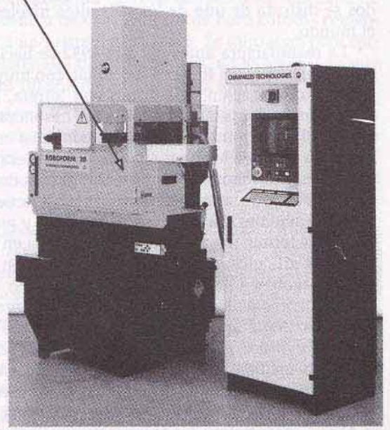
FIGURA 1-12 Las máquinas EDM eliminan porciones de metal mediante un proceso eléctrico de erosión por chispa. (Cortesía de Charmilles Technology Corp.)
