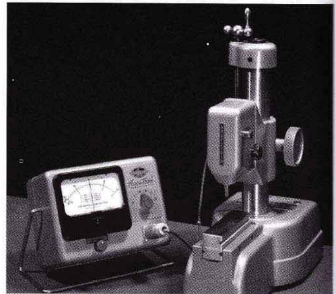
FIGURA 15-7 El valor de las divisiones de escala en un comparador electrónico puede cambiarse fácilmente para adecuarse a la precisión requerida.
