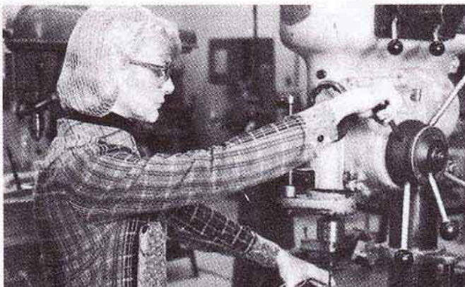
FIGURA 4-5 El cabello largo debe protegerse por una red o con un casco aprobado. (Cortesía de Kelmar Associates).
