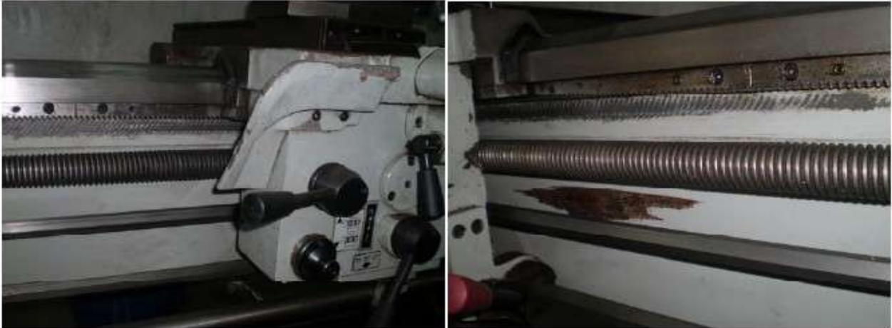
En ambas fotografías se observan en perfil de la cremallera superior, que engrana con un piñón dentro del delantal para el avance automático longitudinal, el tornillo patrón en el centro, y la barra de avances debajo.
