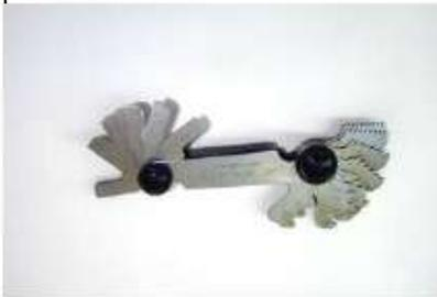
Para calcular la profundidad del roscado, tomamos como ejemplo una rosca exterior W 3/8". El  $\varnothing$  exterior es 9,525. Por tabla de roscas, averiguo que el  $\varnothing$  interior es 8. El ángulo  $\alpha/2$  es  $27^{\circ}30'$ .
